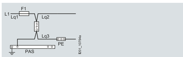
б) Защита ограничителей перенапряжений с использованием предохранителей
