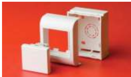
1. Коробки типа PDD для электроустановочных изделий "Viva", "Brava", 45x45 мм. В данные коробки розетки монтируются защелкиванием (без рамок и каркасов). С 4-х сторон коробки имеют перфорацию под все типоразмеры миниканалов серии ТМС
