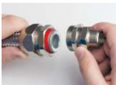
7. Соедините промежуточный корпус и корпус муфты. Надежно затяните с помощью ключей гайку, промежуточный корпус и корпус муфты для получения заявленной степени IP и надежности фиксации оплетки металлорукав
