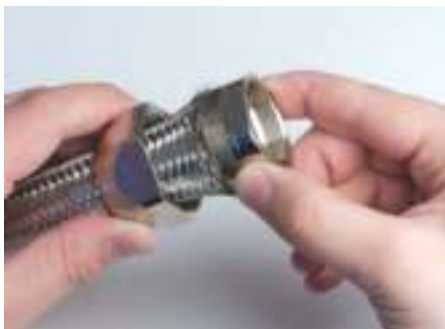
2. Установить промежуточный корпус под оплетку, предварительно удалив скотч с металлорукав. Плотно зафиксировать гайку и промежуточный корпус между собой, тем самым закрепив оплетку металлорукав в аксессуаре
