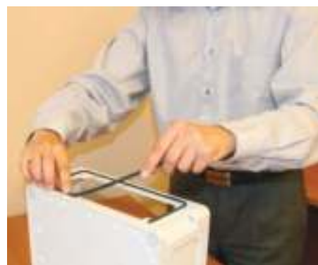
3. Установите уплотнитель на оба объединяемых корпуса
