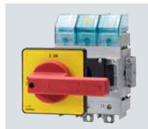
Выключатель 3LD2 418-0TK13 для крепления на монтажной плате, 250 А, с поворотным приводом и дверной муфтой
