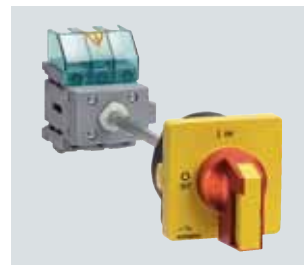
Выключатель 3LD2 217-1TL13 для крепления на монтажной плате с поворотным приводом и отключаемой дверной муфтой
